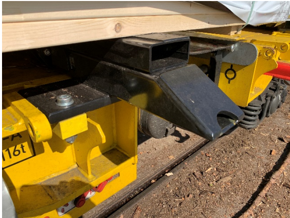
Abbildung 35 Greiferschutz (Abweiser) klappbar
