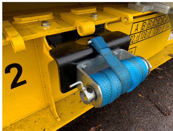
Abbildung 25 Sicherung des Gurtes an der Konsole der Winde
