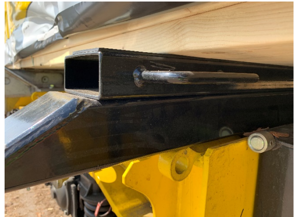
Abbildung 35 Greiferschutz (Abweiser) klappbar
