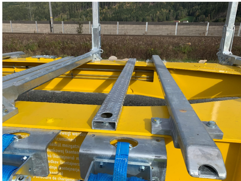
Abbildung 36 Greiferschutz (Abweiser) - Beispiel
