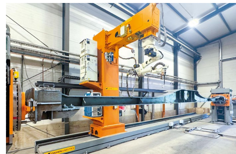
Saldatura robotizzata di un telaio di carro
