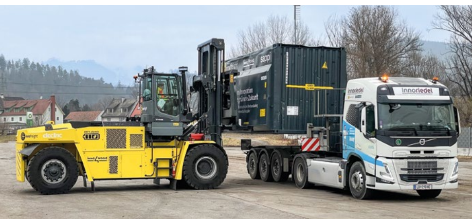
Trasbordo di WoodTainer XXL con carrello elevatore elettrico su un camion elettrico
