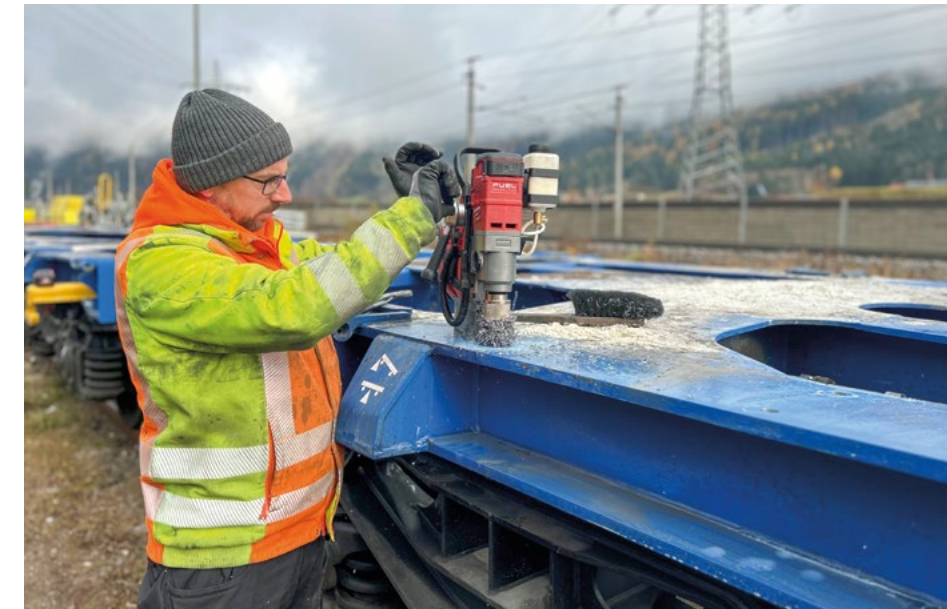
Preparativi per il montaggio dei montanti su un InnoWagon
