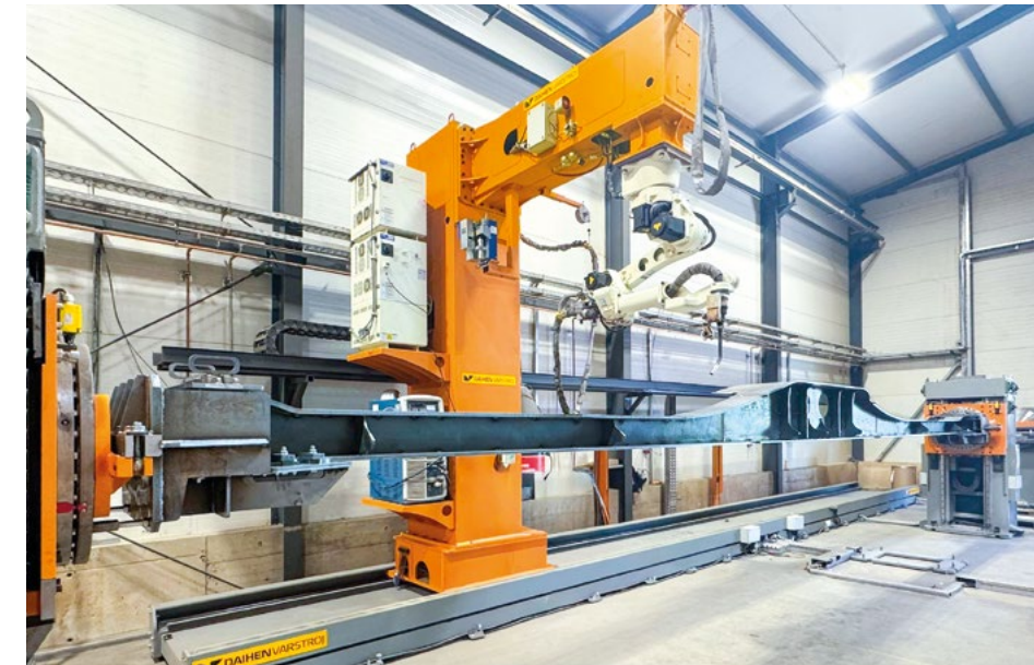
Roboterassistiertes Schweißen eines Wagonrahmens
