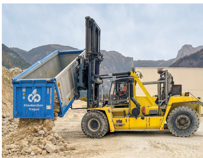
Entladung mit Drehentladestapler
