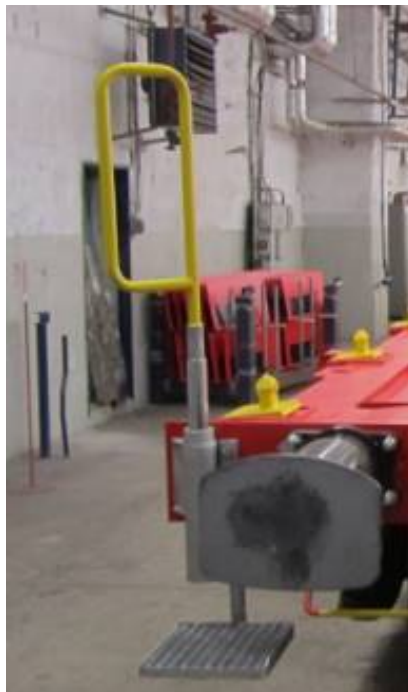
Abbildung 6 Klappbarer Handgriff – Aufgestellt
