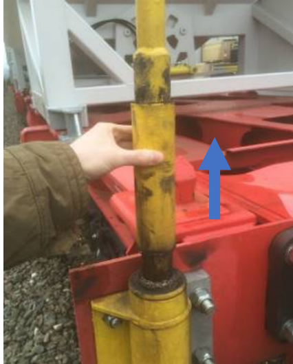
Abbildung 7 Klappbarer Handgriff – Hülse hochheben
