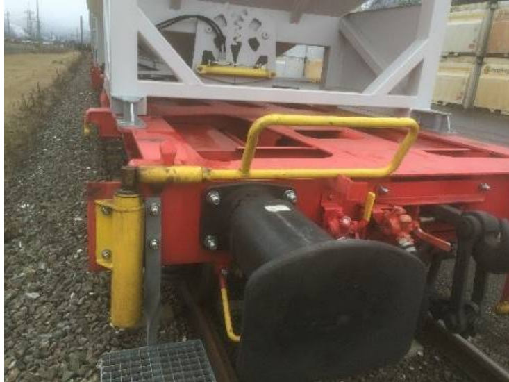
Abbildung 9 Klappbarer Handgriff – Waagrecht liegend in Haltevorrichtung
