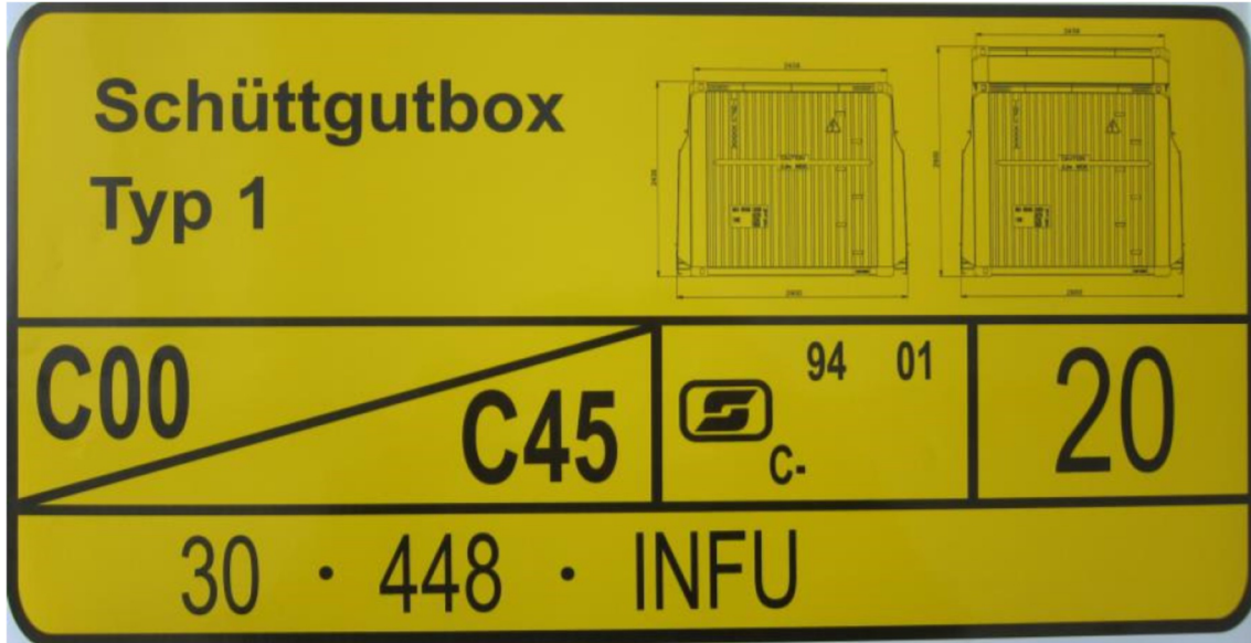
Beispiel: gelbes Kodifizierungsschild gemäß UIC 596-6
