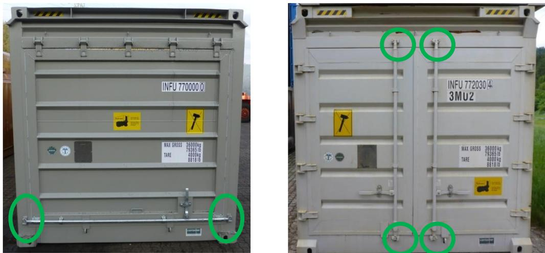
Abbildung 136: Variante F, Heckklappe und Hecktüren schließen F.2.
