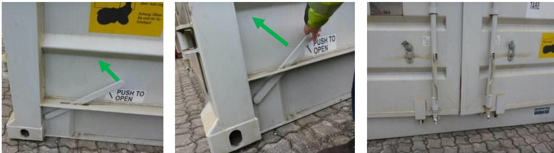
**Abbildung 135: Variante F, Heckklappe und Hecktüren öffnen E.4.**
