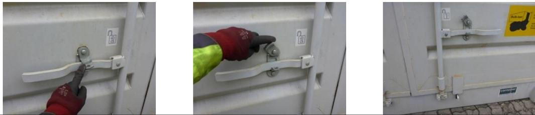
**Abbildung 131: Variante F, Heckklappe und Hecktüren öffnen E.2.**
