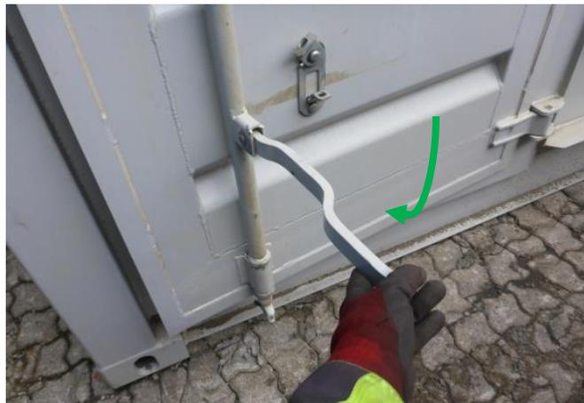
**Abbildung 202: Variante L, Seitentür öffnen B.2.1.3.**
