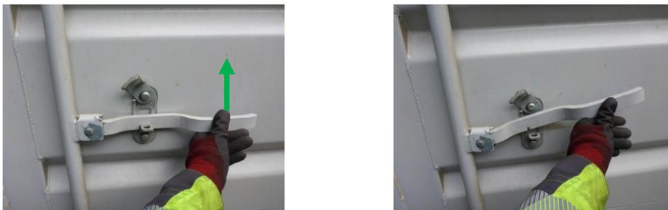
**Abbildung 122: Variante F, Seitentür öffnen C.2.**
