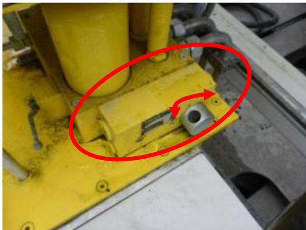
**Abbildung 108: Variante E, Einstellung Leitblech C.13.**
