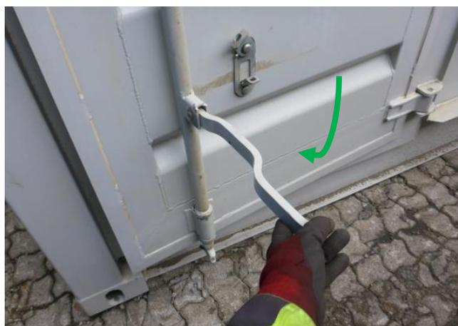
**Abbildung 123: Variante F, Seitentür öffnen C.3.**
